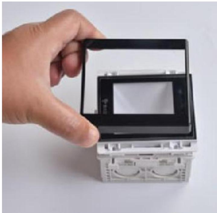
④ 用螺丝刀插入卡口位置拨动卡扣，让主体部分和安装框分离。
