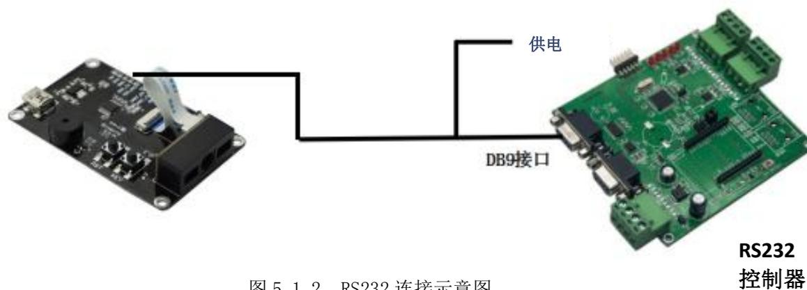
图 5.1.2 RS232 连接示意图
