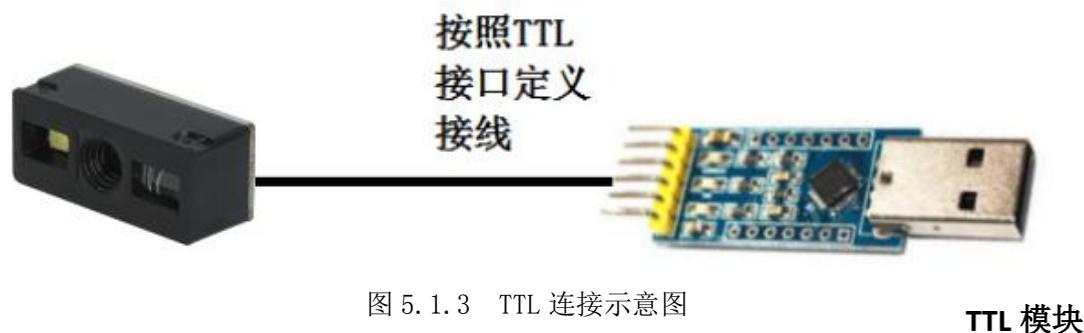
图 5.1.3 TTL 连接示意图
